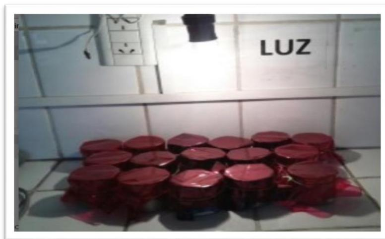
Figura 18. Pesafiltros con papel celofán utilizados en el ensayo de luz.
