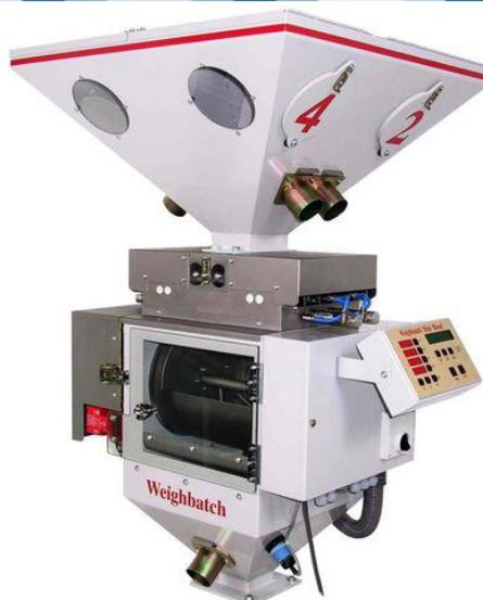
Figura 3-6 – Mezclador gravimétrico
