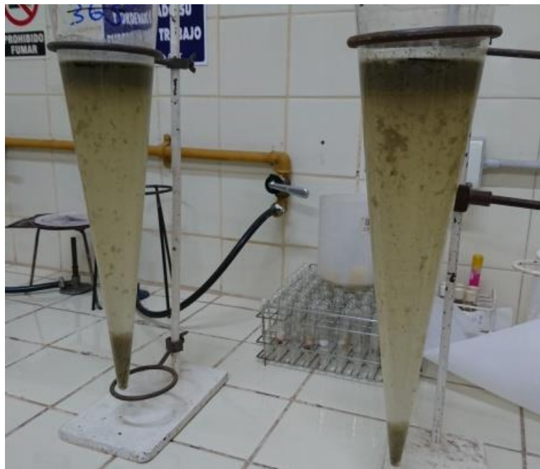
Figura 13. Medición de sólidos sedimentables en cono de Imhoff
