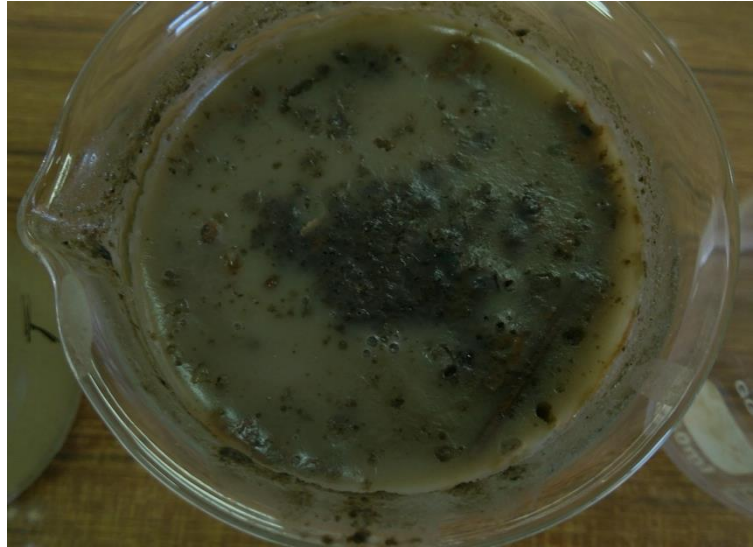
Figura 11. Solidificación de la fase hidrofóbica por enfriamiento (compárese con la figura 10) Fuente: Propia
