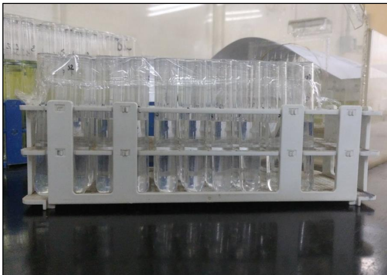
Figura N°17 Fotografía de gradilla con las muestras de agua preparadas con el patrón interno de escandio y con ácido nítrico
