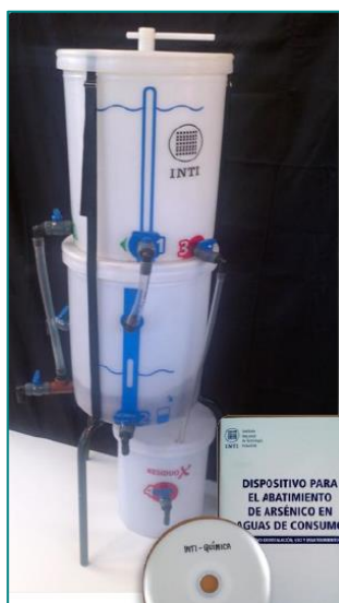
Figura N°6 Dispositivo de abatimiento de arsénico (10)
