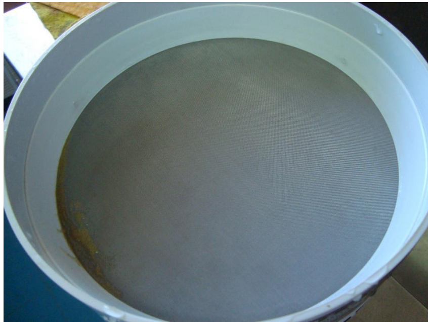
Tamiz N° 70 (149 \mu\text{m} ) con restos de material de donde se toma una submuestra para armar los slides.
