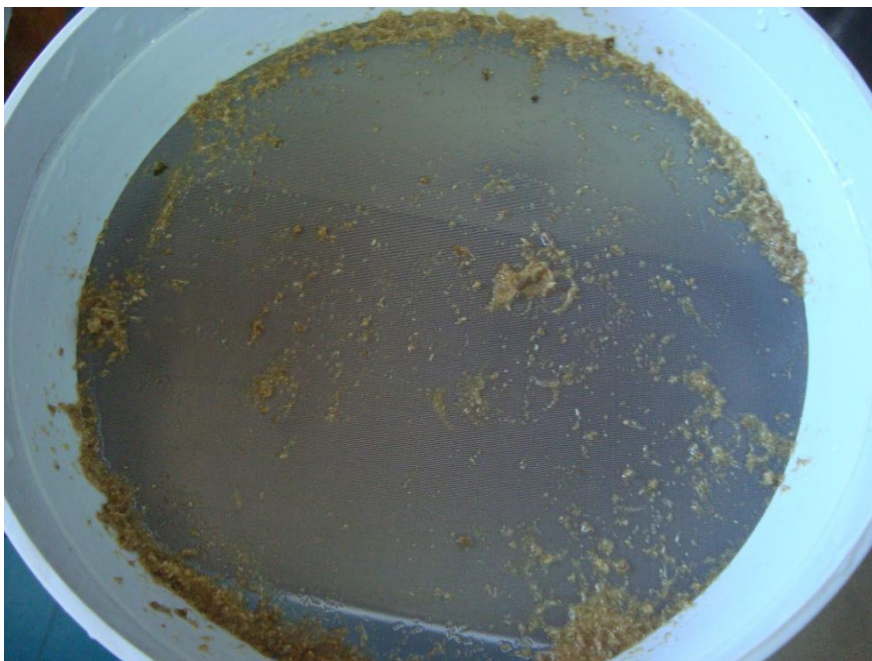
Tamiz N° 100 (210 \mu m) con restos de material que ya ha sido clarificado.
