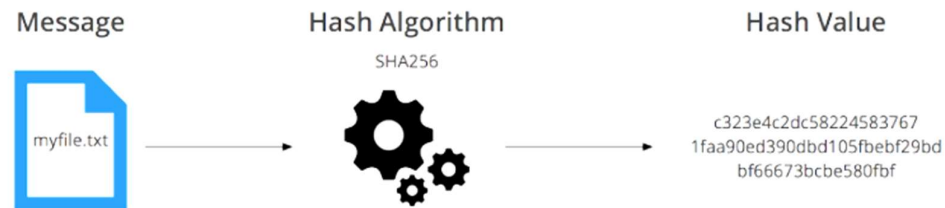
Figura N° 4: Proceso de certificación usando la blockchain
