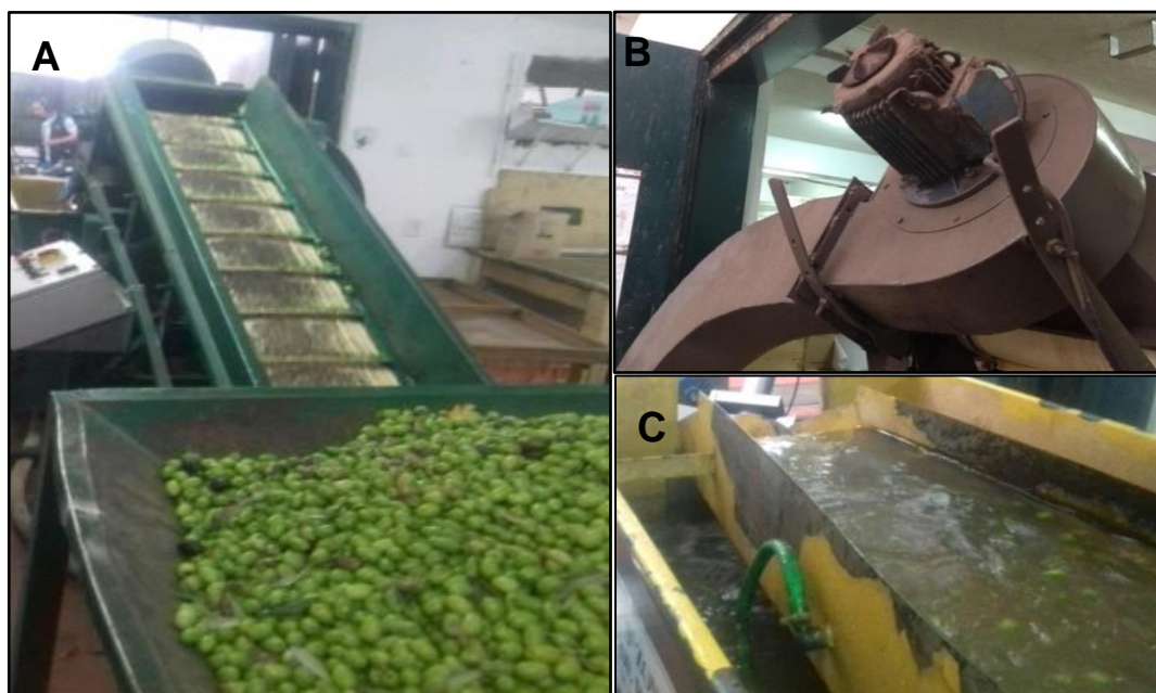
Figura 13. Preparación de las aceitunas. A) Tolva receptora y cinta transportadora, B) Despalladora, y C) Cuba de lavado. Fuente: Chumbita (2017).
