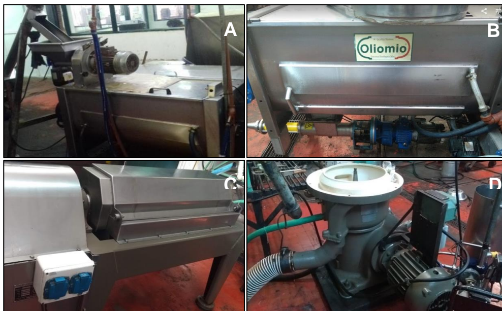
Figura 14. Procesamiento de las aceitunas. A) Molino y termoamasador, B) 2° amasador, C) Centrífuga horizontal o decanter, D) Centrífuga vertical. Fuente: elaboración propia.
