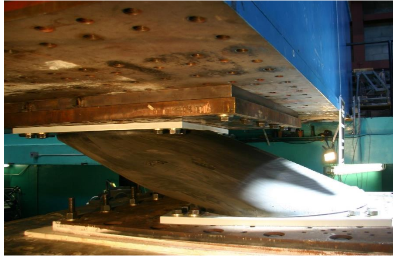
Figura 23: Desplazamiento de un aislador
