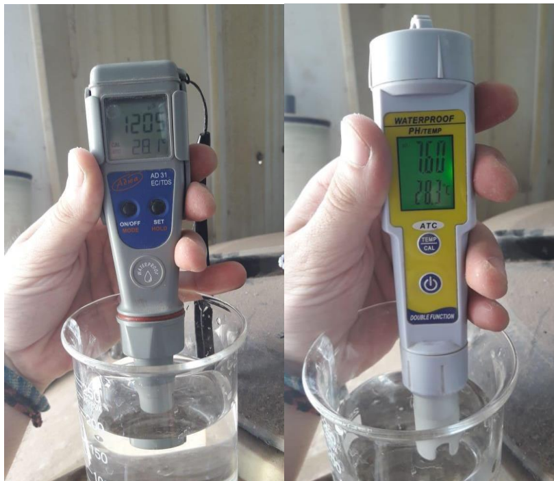
Figura 25. Medición de conductividad (izquierda) y pH (derecha) de los rechazos derivados de la ósmosis. Fuente: Elaboración propia.
