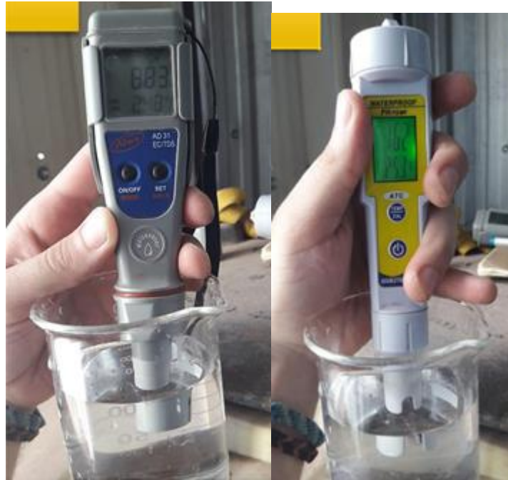
Figura 26. Medición de conductividad (izquierda) y pH (derecha) del agua de entrada. Fuente: Elaboración propia.
