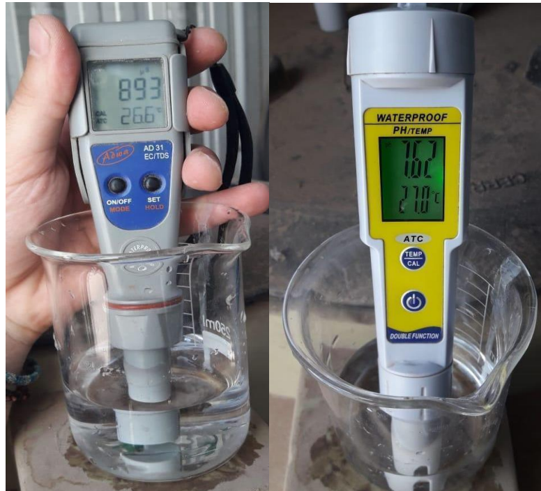
Figura 24. Medición de conductividad (izquierda) y pH (derecha) de los rechazos derivados del prefiltrado. Fuente: Elaboración propia.
