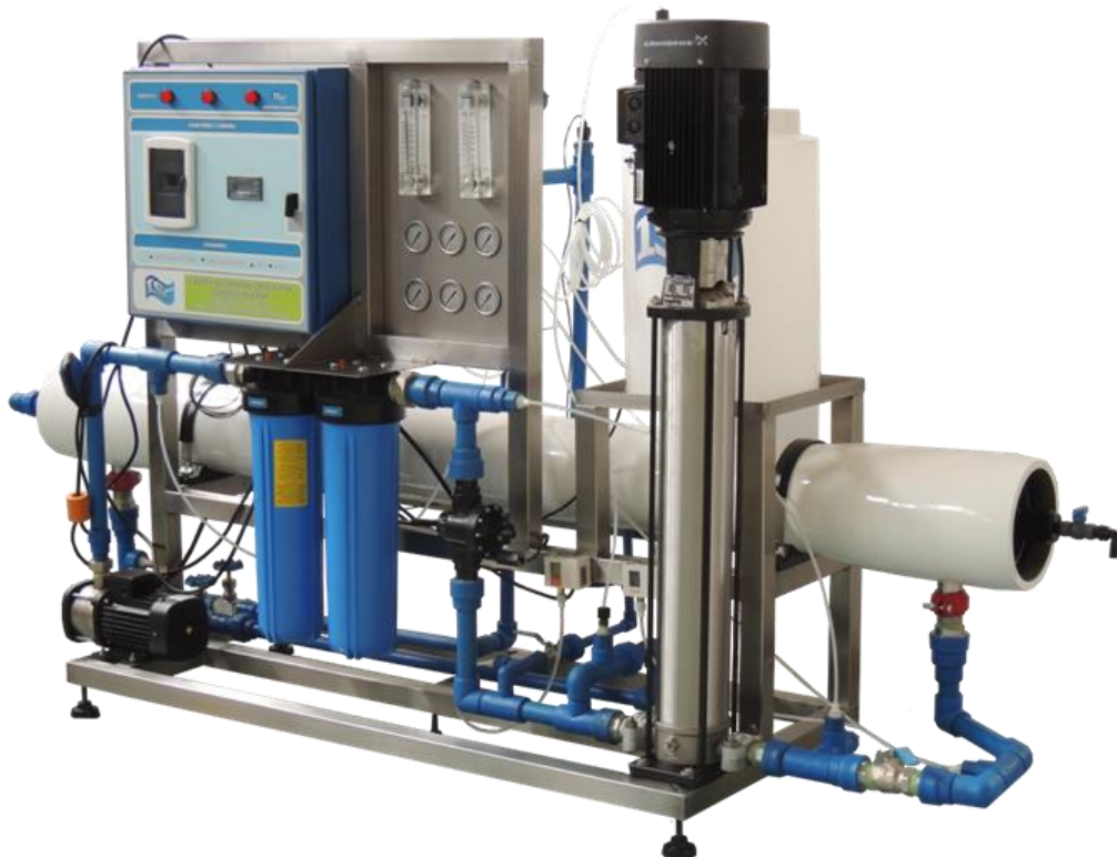
Figura 5. Equipo similar al que se utiliza en la Fábrica de cerveza de 23R. Fuente: https://ingsiri.com.ar/productos/osmosis-inversa/ .
