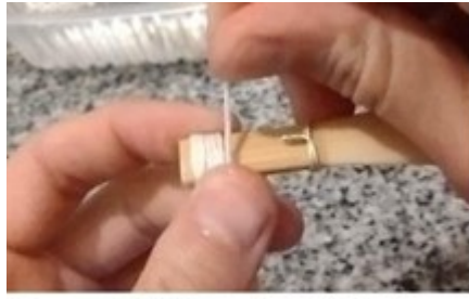
Imagen 11: Colocación del hilo de algodón para el armado
