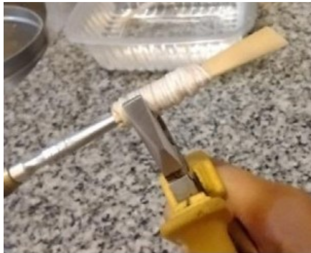
Imagen 12: Inserción del mandril y redondeo del tubo
