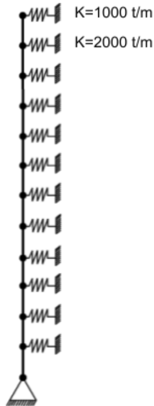
Fig 6.5.3.3: Modelo de Winkler para determinación de K_h y K_r
