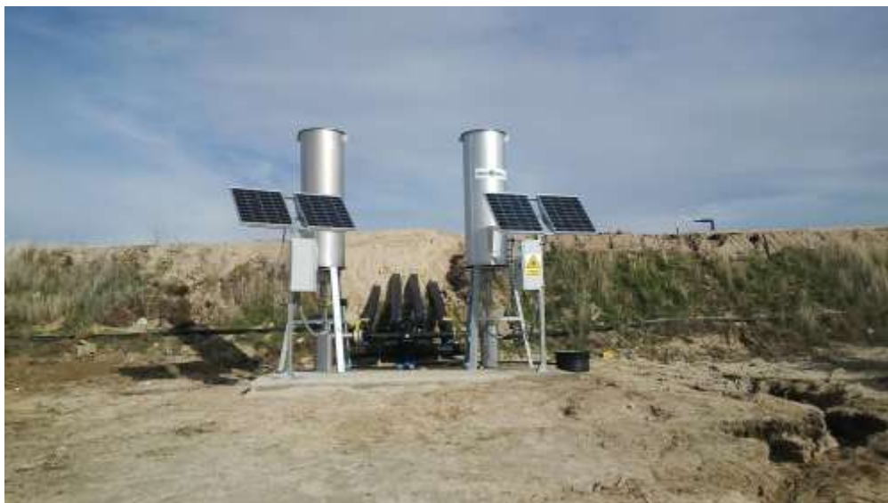
Figura 6.16: Antorcha estática de tipo cerrada Fuente: CONVECO SRL
