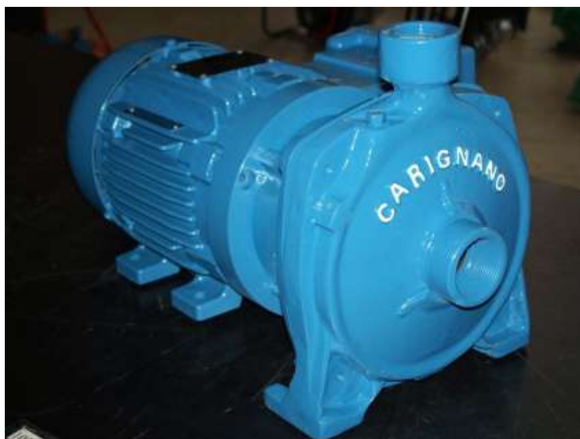
Figura 6.19: Bomba de recirculación de lixiviados
