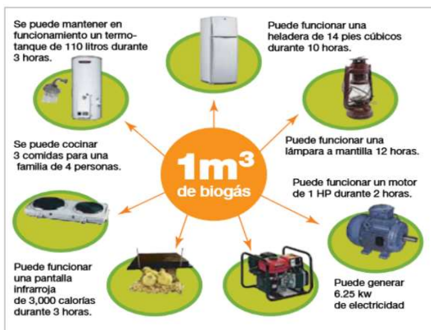
Figura 5.15: Aplicaciones del biogás
