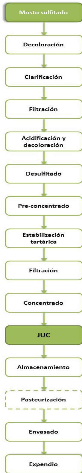
Figura 1. Esquema del proceso para la elaboración de JUC. Adaptado de Rojo (2014).
