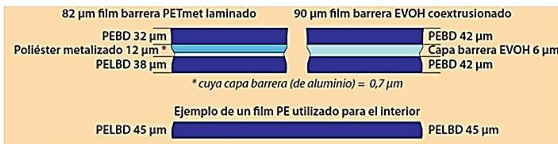
Figura 3 - 9: Composición general de bolsas tipo bag in box, con barrera de poliéster metalizado con aluminio y barrera de EVOH
