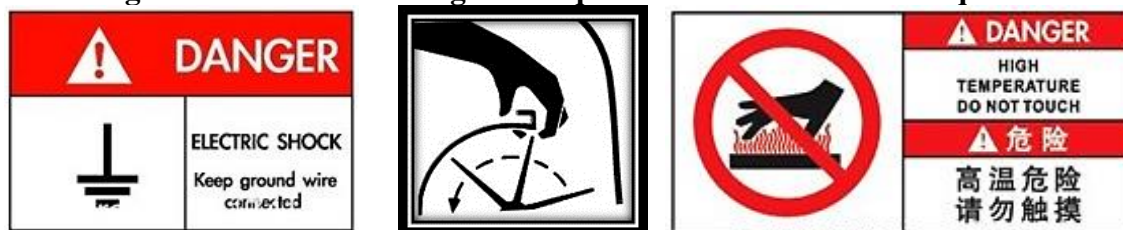
Figura 8 - 4: Señales de seguridad que se encuentran en las máquinas.
