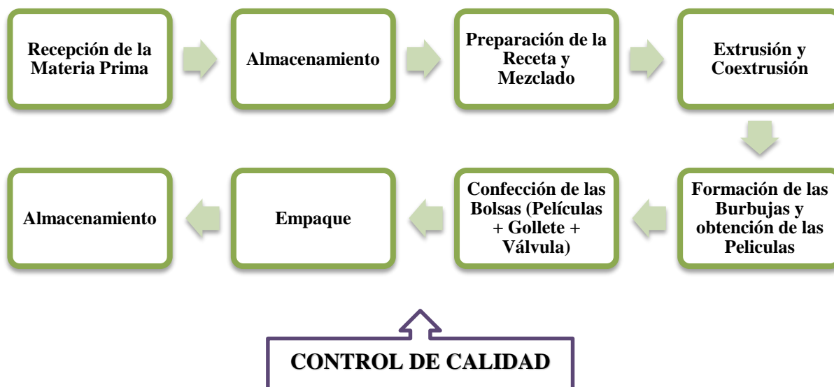
Figura 3 - 31: Diagrama de Flujo para la producción de bolsas BiB
